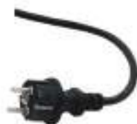
Cavo / Cable 300cm, H05RN-F 3G1.0mm 2
